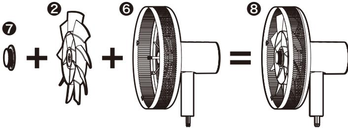
**주의** 보호망이 정확히 Lock 되지 않은 상태에서 사용하시는 것은 매우 위험합니다. 정확하게 보호망이 Lock 되었는지 확인 후에 사용하시기 바랍니다.
